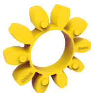
Ozubený věnec pro vysoké teploty z polyuretanu 92° Shore A
